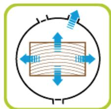
1 - Installation de la palette complète de votre kit dans le tunnel appelé autoclave puis extraction sous vide de l'air s'y trouvant.
