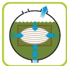
2 - Remplissage sous vide du tube avec la solution : THANALITH E3475
